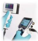
contaminometre de radiații alfa, beta, gama
